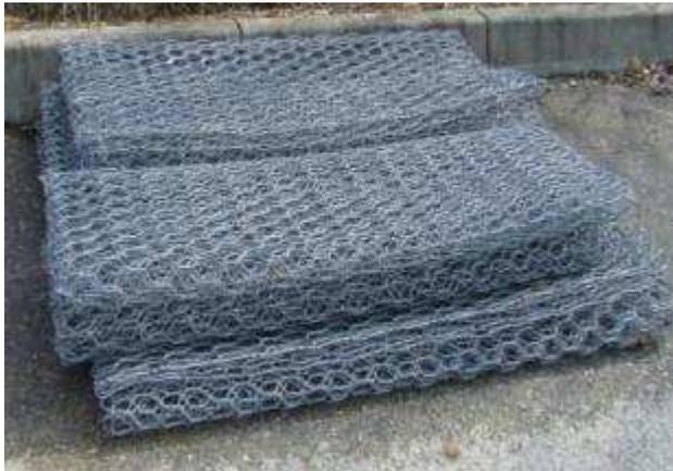
Figure 13: Gabions à double torsion
