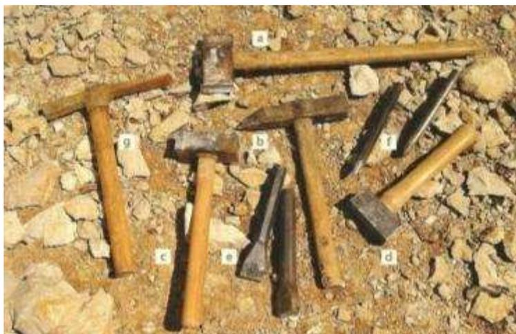
Figure 11: Différents types de chasses, d'aiguilles et de têtus
